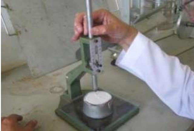
FIGURA 1 - Técnica para a determinação dos tempos de pega, utilizando-se o Vicat. Fonte: Savi, 2012.
