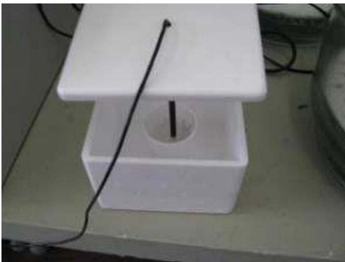
FIGURA 2 – Técnica para a determinação dos tempos de pega, utilizando-se o Calorímetro. Fonte: Savi, 2012.
