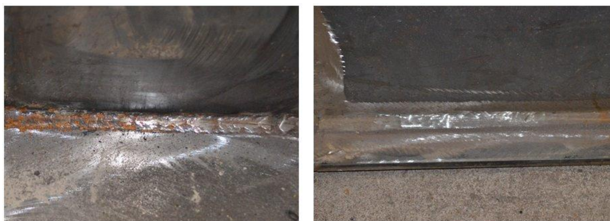
FIGURA 2: Solda Péssima X Solda Excelente. Fonte: Cofama, 2011
