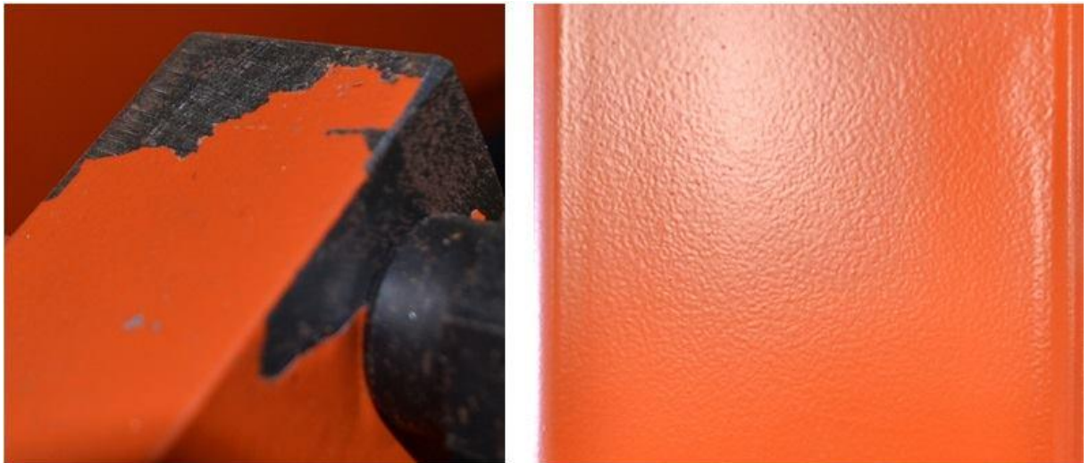
FIGURA 2: Pintura Péssima X Pintura Excelente. Fonte: Cofama, 2011
