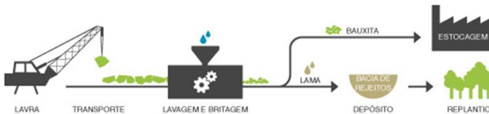
FIGURA 2 - Processo do escoamento da Bauxita.
