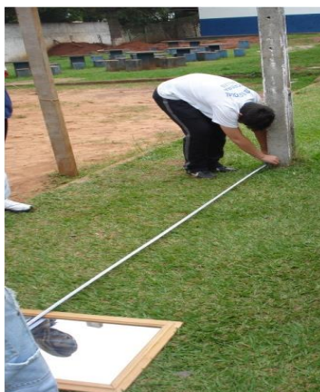
Figura 7: Usando espelho para determinar altura inacessível Fonte: Autores
